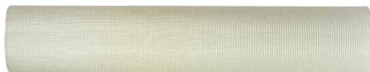
Flächenarmierung für Lehmklebe- und Armierungsmörtel und alle Lehmputze. CLAYTEC-Glasgewebe ist ein Drehergewebe aus Glasseidengarn/Roving, appretiert mit Polymerausüstung. Es ist zugfest, sehr fein und besonders gut zu verarbeiten.
