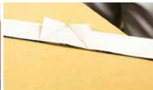
4. Den schmalen Liner nach hinten klappen und die Ecken zu einem Dreieck auf falten
