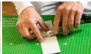
2. Das breite Trennpapier mittig auf der Rückseite des Klebebandes einschneiden
