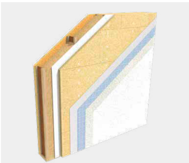
Holzrahmenkonstruktionen mit Plattenwerkstoff außen
